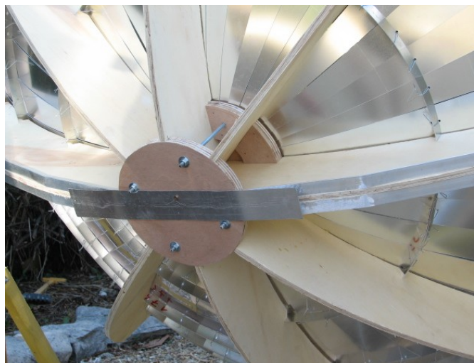
Bande aluminium entre les renforts arrière
