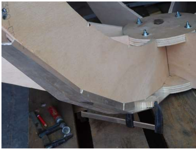
Pose des renforts en cornière aluminium
