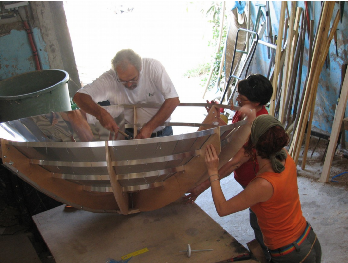
Montage des réflecteurs
