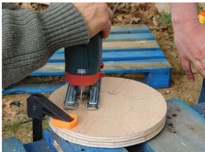
Découpe des cales des disques de serrage
